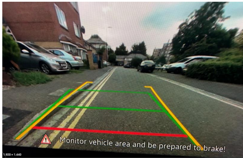
Εικόνα 2.7: Ζωντανό στιγμότυπο εικόνας κάμερας όπισθεν αυτοκινήτου όπου εφαρμόζεται Μηχανική Όραση
